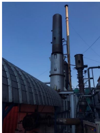
เตาเผาคว้น (Secondary burner)
