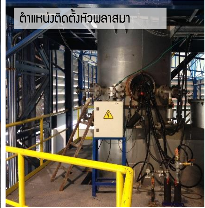
ช่องเติมเชื้อเพลิง และฝาเปิด-ปิด อัตโนมัติ
